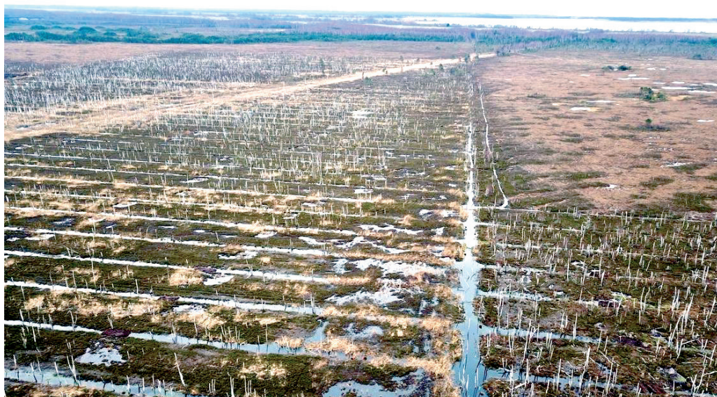
7 pav. Durpinio grunto užtūromis patvenkti grioviai šiaurinėje Aukštumalos TD dalyje, 2018 m. spalio. Ž. Sinkevičiaus nuotr. Fig. 7. Water level rising in the ditches closed by peat dams in the northern part of Aukštumala TR, October 2018
