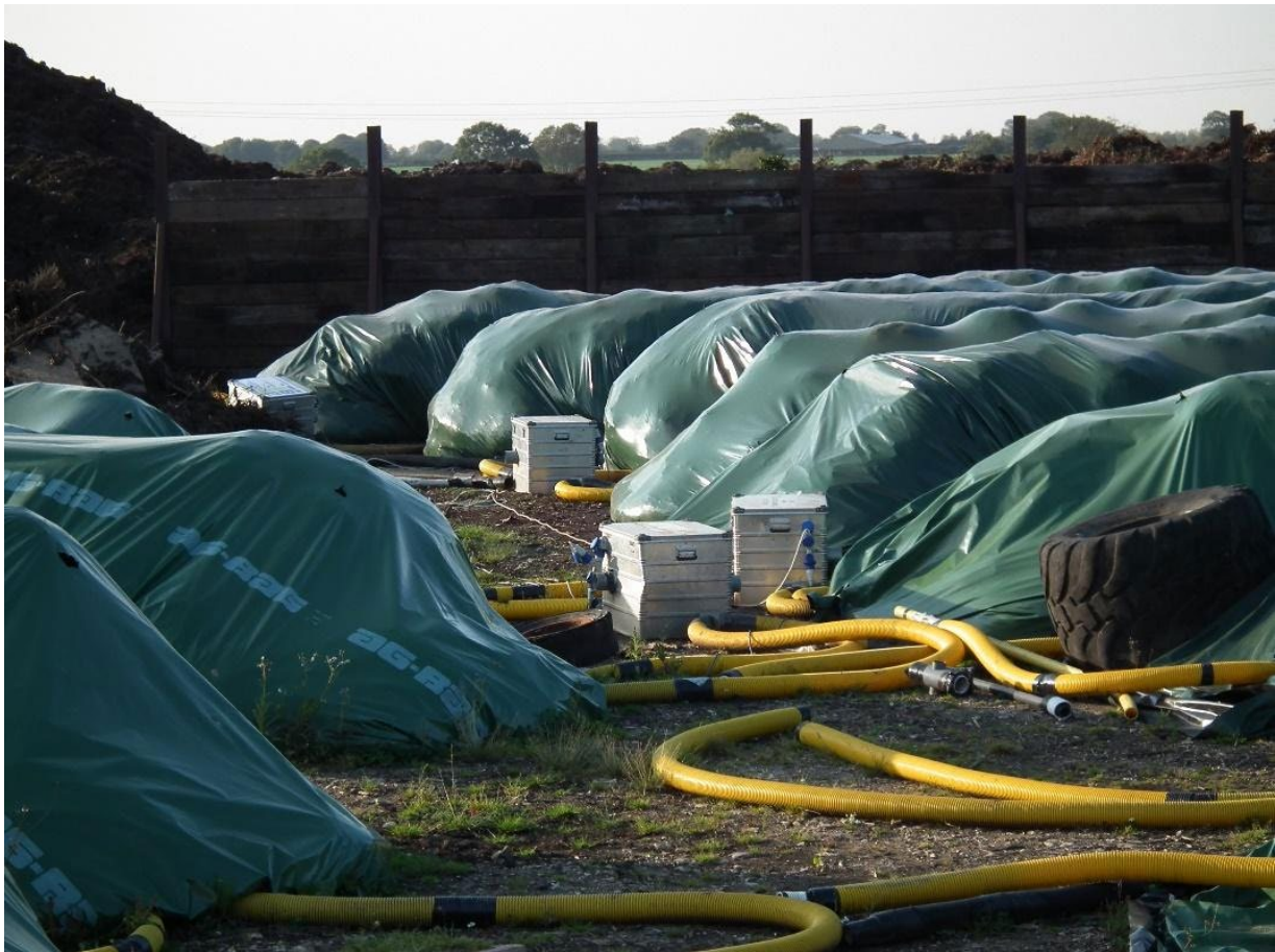
Kompostavimas plastikiniuose „tuneliuose“ su priverstine oro cirkuliacija. Norfolk, Didžioji Britanija. Łukasz Mucha nuotr.
