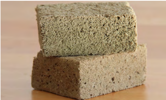
Pelkininkystės produktų prototipai, pagaminti Vokietijoje iš šlapiuose durpiniuose dirvožemiuose užaugintos biomasės: kietojo plaušo plokštės baldų gamybai, konstrukcinės plokštės, pastatų apšildymo medžiagos ir vienkartiniai indai
