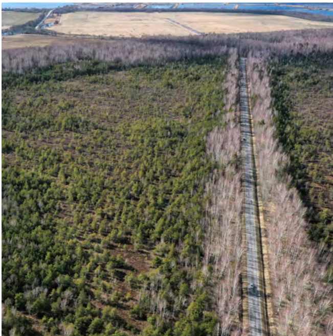
Pietvakarinėje Aukštumalos aukštapelkės dalyje (kairėje) įrengtas vandenį sulaikantis pylimas (dešinėje)
