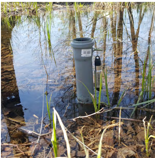
Įrengta hidrologinio monitoringo sistema.
